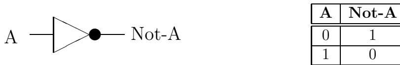
Figura 3: Representação esquemática da porta NOT
