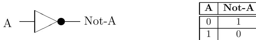
Figura 3: Representação esquemática da porta NOT
