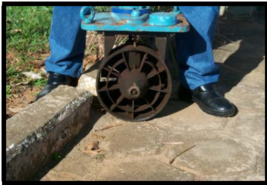
Figura 2.1 – Turbina do macro Woltman
