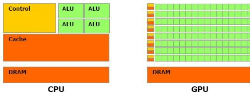
Figura 3.1: Destinação dos transistores em GPUs e CPUs (NVIDIA CUDA, 2009).
