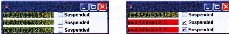
Figura 23.18 RandomCharacters cria um JFrame com três RunnableObjects e três JCheckBoxes para permitir ao usuário suspender e retomar as threads. (Parte 3 de 3.)
