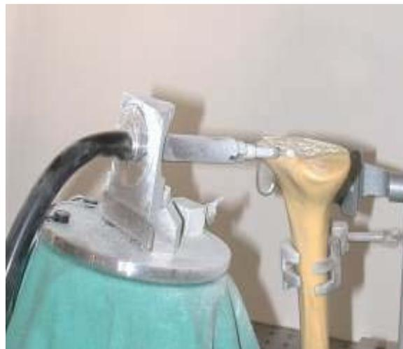
**Figura 16:** Robô protótipo executando uma operação em um joelho
